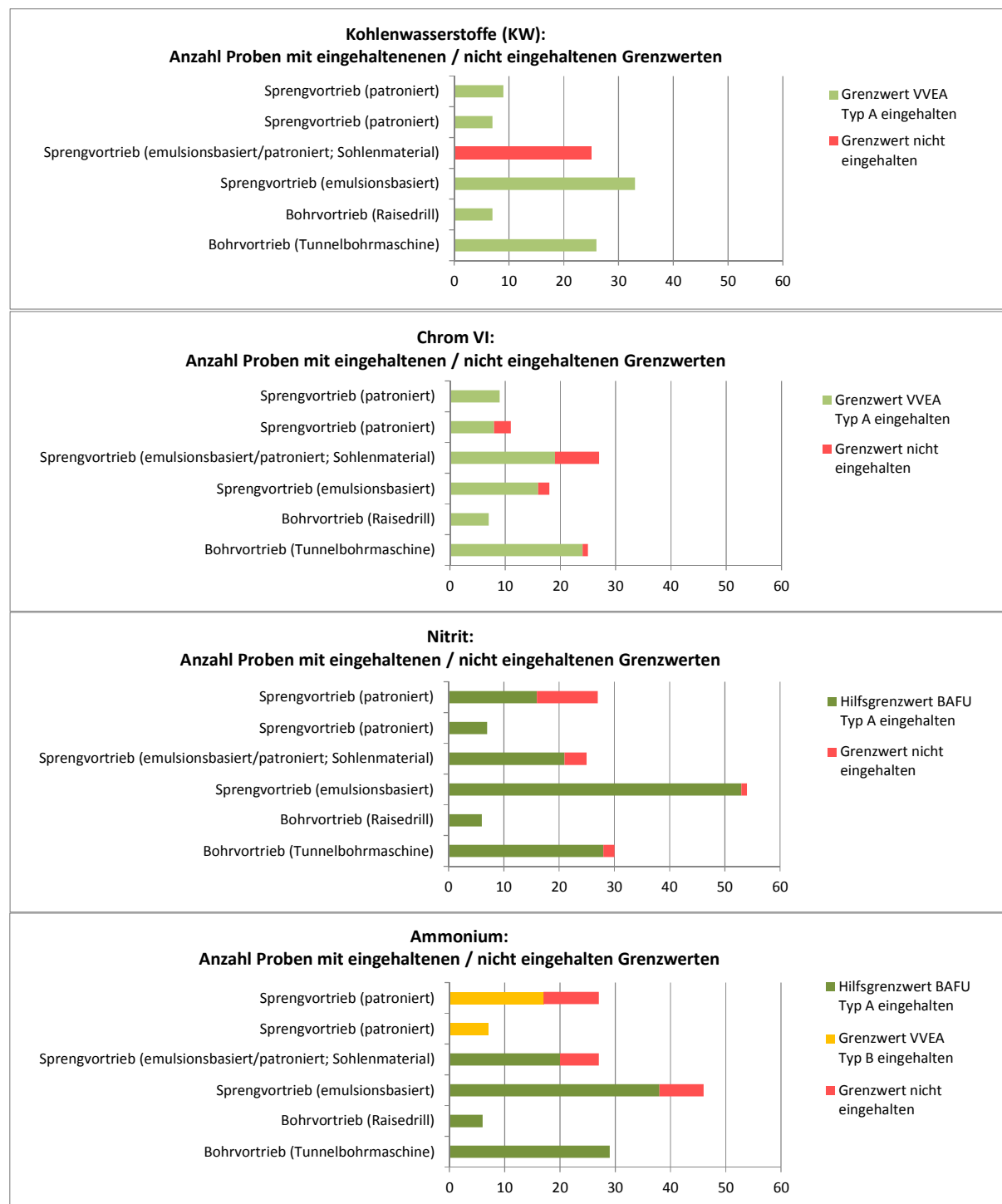
Abbildung 5: Schadstoff-Messungen im Tunnelausbruchmaterial von Tunnel-/Stollenbauprojekten
